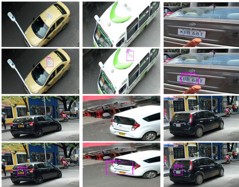
Figura 6. Detección de las placas vehiculares. Fuente: Autores.
