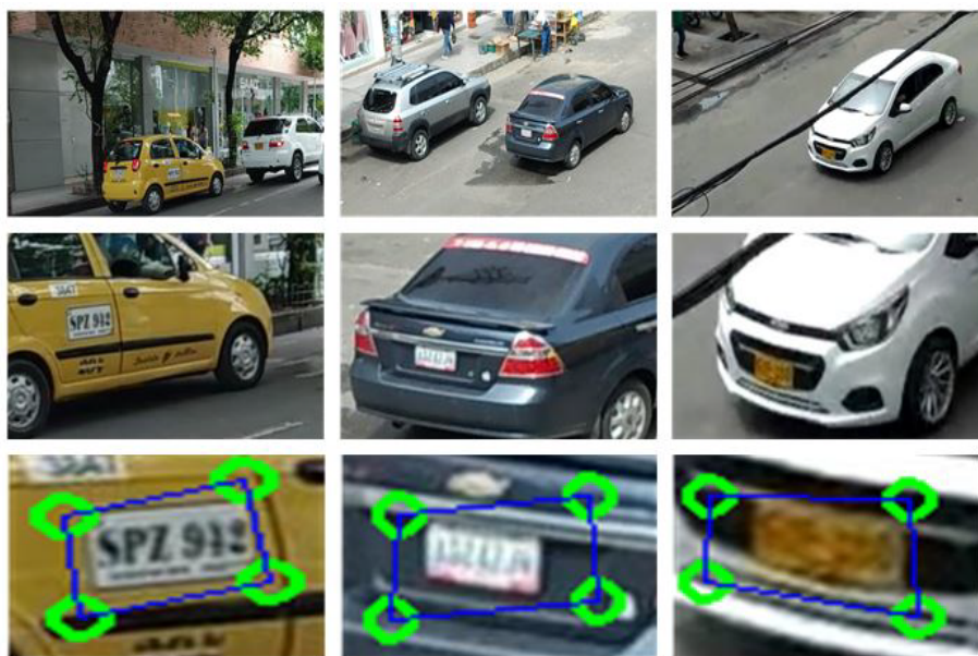
Figura 6. Adquisición y modificaciones iniciales a la imagen. Fuente: Autores.
