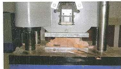
Figura 1 Ensayo de compresión en ladrillos
