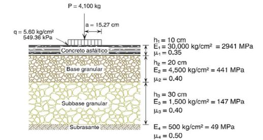
Figura 1. Modelo estructural de referencia de pavimento
