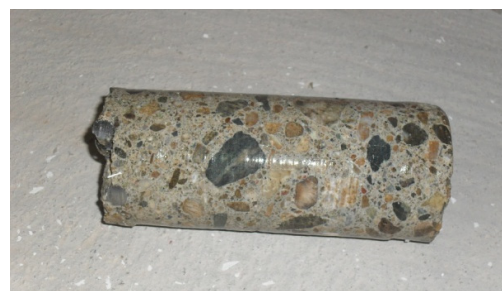
Foto 3. Cilindro de concreto, extracción de núcleo zapata F3. Fuente: Y. Motta y M. Pérez
