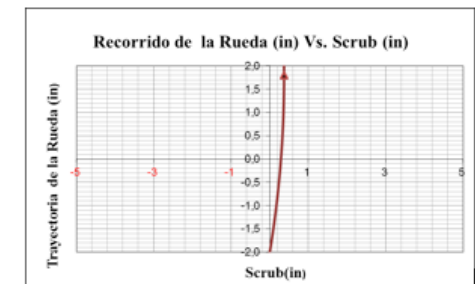
Figura 4. Recorrido de la rueda Vs Scrub
