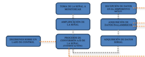
Figura 5. Etapas físicas (módulos) del sistema piloto
