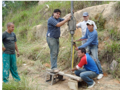
Figura 3. Realización ensayo SPT. Fuente: Autores.
