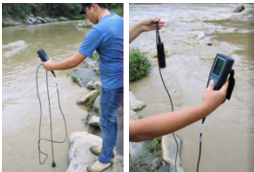
Figura 4. Toma de muestras para análisis fisicoquímico (Oxígeno disuelto, Ph y Conductividad) con la sonda multiparamétrica. Biólogo Oscar Eduardo Rangel Parra. Fuente: Esta investigación. Foto: José Arnoldo Granadillo Cuello, 2012.
