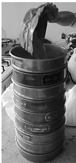
Figura. 4: Cernido De La Arcilla Prueba De Laboratorio
