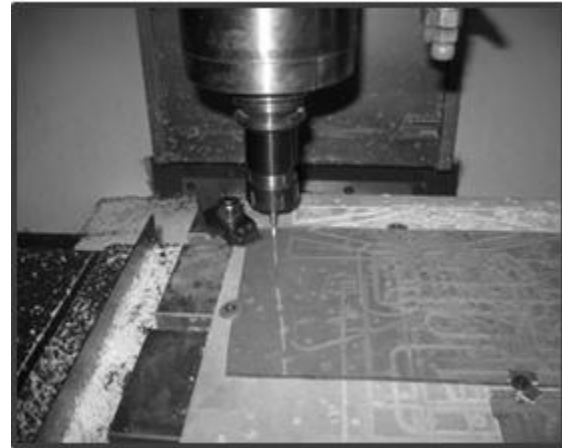
Figura. 5. Proceso de manufactura en la fresadora CNC.
