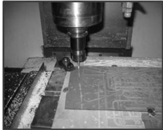
Figura. 5. Proceso de manufactura en la fresadora CNC.
