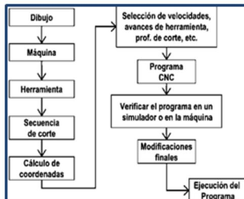
Figura 1. Flujo del procesamiento del CNC
