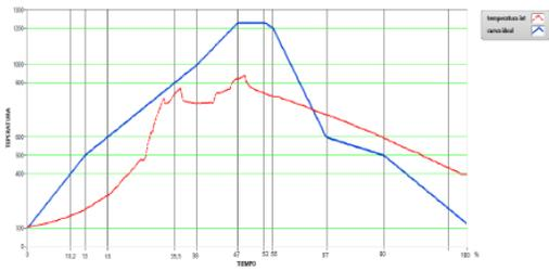
Figura 9. Comparación de la curva ideal con el proceso real. Horno Hoffman.
