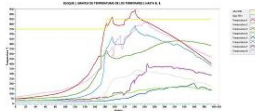
Figura 8. Adquisición horno Hoffman.
