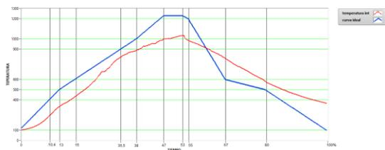
Figura 11. Comparación de la curva ideal con el proceso real. Horno circular.
