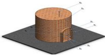
Figura 7. Ubicación de los termopares. Horno circular.
