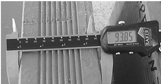
Figura 3. Medición de dimensiones de los productos de mampostería de perforación horizontal. Fuente: Elaboración Propia.
