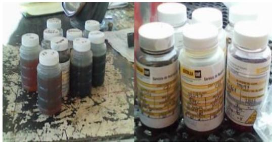
Figura 10. Muestras de aceite debidamente etiquetadas.
