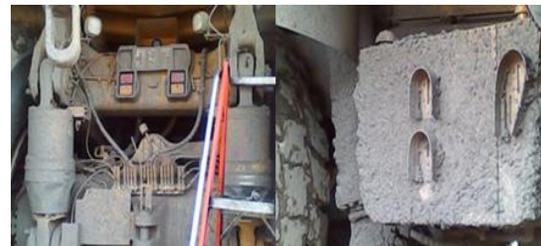
Figura 1. Equipo sin el lavado adecuado para mantenimiento preventivo
