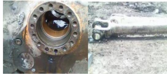
Figura 4. Componentes no protegidos durante la ejecución de trabajos de mantenimiento
