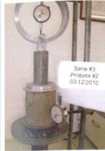
Figura 3. Ensayos de compresión sin confinamiento
