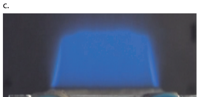
Figura 6. Estabilidad de llama: a) y b) Imagen de inestabilidades de llama, c) Llama estable.
