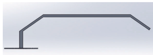
Figura 7. Pinzas de la máquina de soldadura por puntos, vista lateral.
