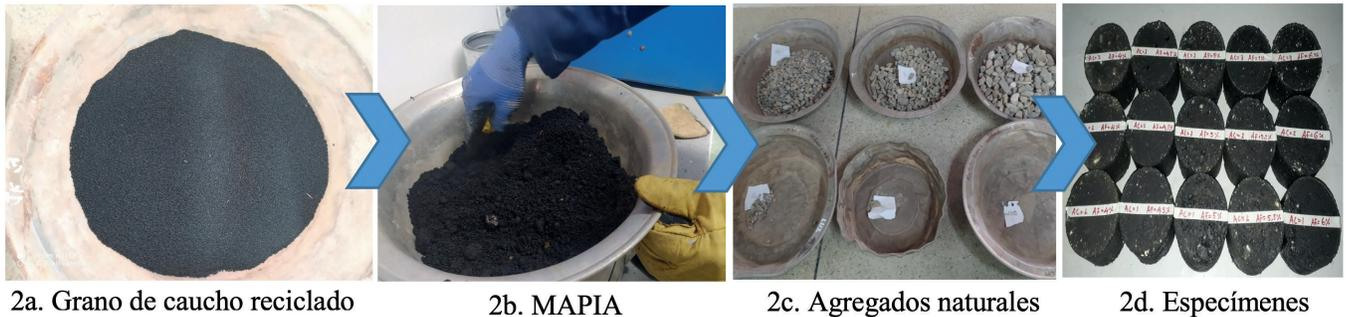
**Figura 2.** Elaboración de especímenes Marshall
