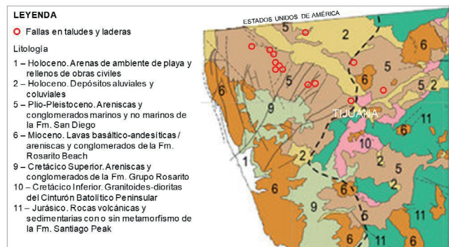
Figure 3. Fallas de taludes y laderas registradas en el área urbana de Tijuana (entre 2010 y 2020).
