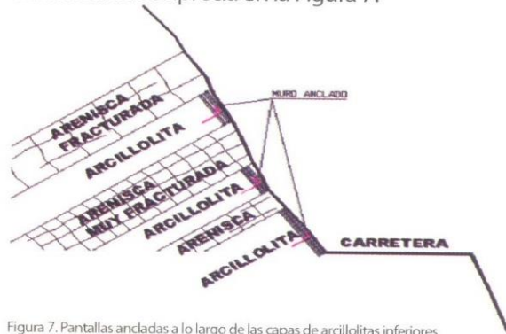
Figura 7. Pantallas ancladas a lo largo de las capas de arcillolitas inferiores
