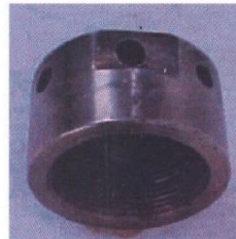
Fig. 6. Dispersor de la boquilla de combustible
