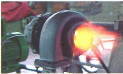
Fig. 7. Turbojet en el momento del encendido
