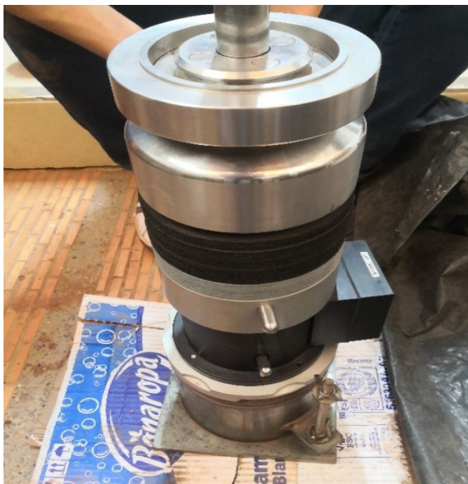
Figura 5. Ensayo de LWD en molde de 6".
