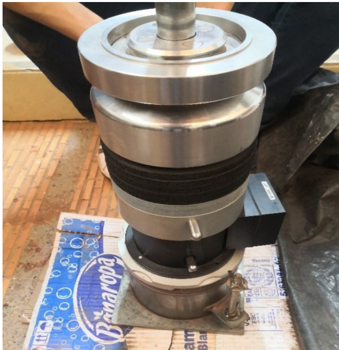
Figura 5. Ensayo de LWD en molde de 6".
