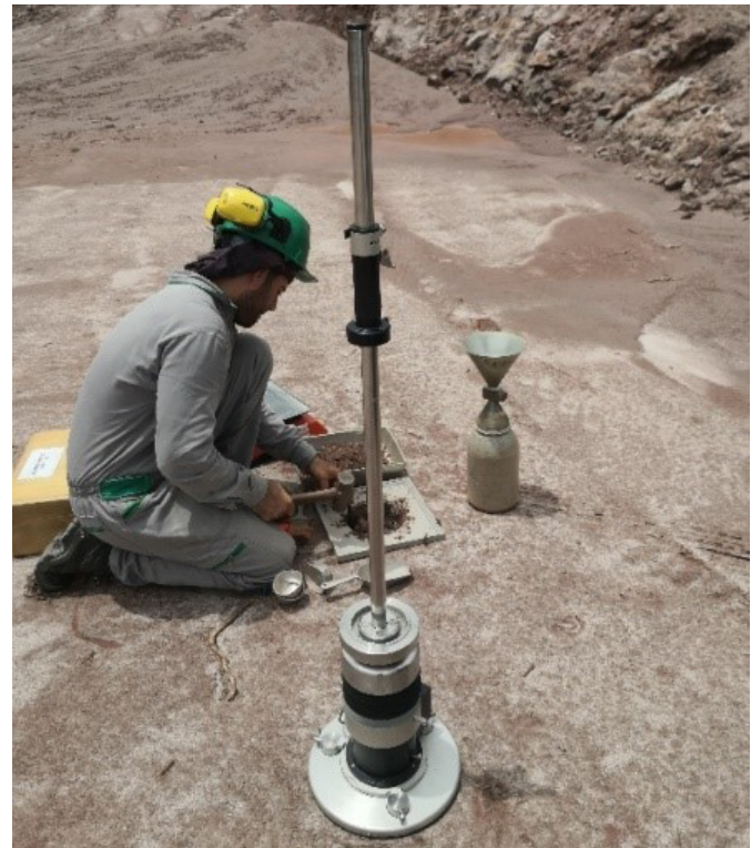
Figura 6. Ensayo de LWD y cono y arena en campo.
