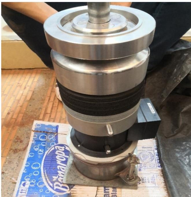
**Figura 5.** Ensayo de LWD en molde de 6".
