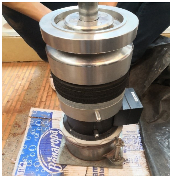
Figura 5. Ensayo de LWD en molde de 6".
