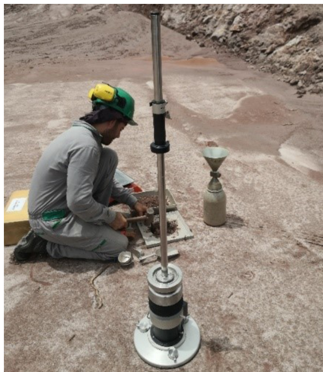
Figura 6. Ensayo de LWD y cono y arena en campo.
