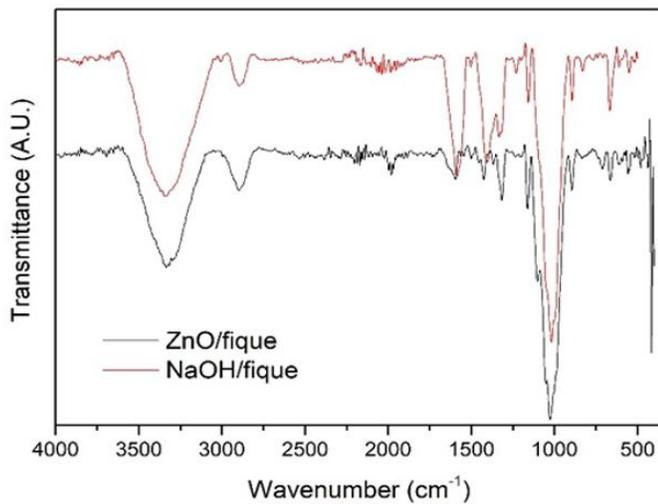
Figure 6. FTIR ZnO/fique and NaOH/fique.
