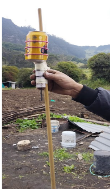
Figura 8. CANSAT implementado en volador
