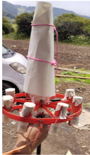
Figura 9. CANSAT implementado en volador de rotación
