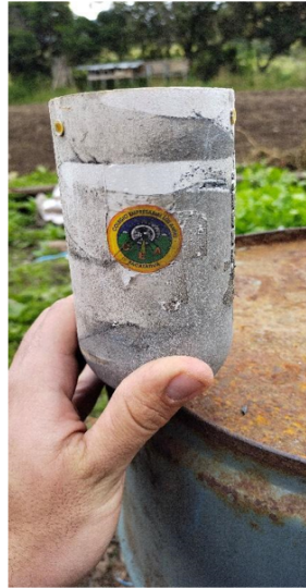
Figura 5. Carcasa protección CANSAT
