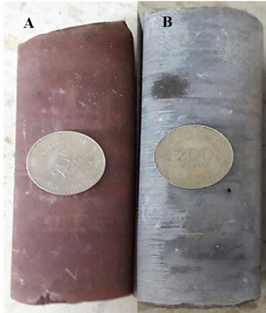
Figura 5. A. Limolita de la Formación La Quinta. B. Caliza del Grupo Cogollo.
