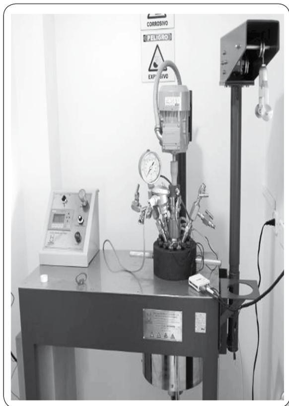
Figura 2. Reactor de alta presión y temperatura
