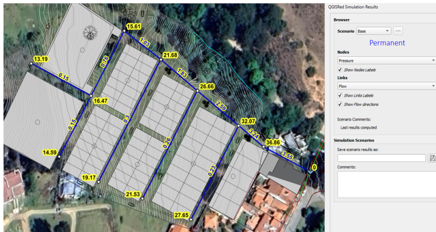
Figura 11. Cálculo hidráulico en QGISRed del modelo 2 en modo instantáneo, presiones y velocidad en la RDAP.
