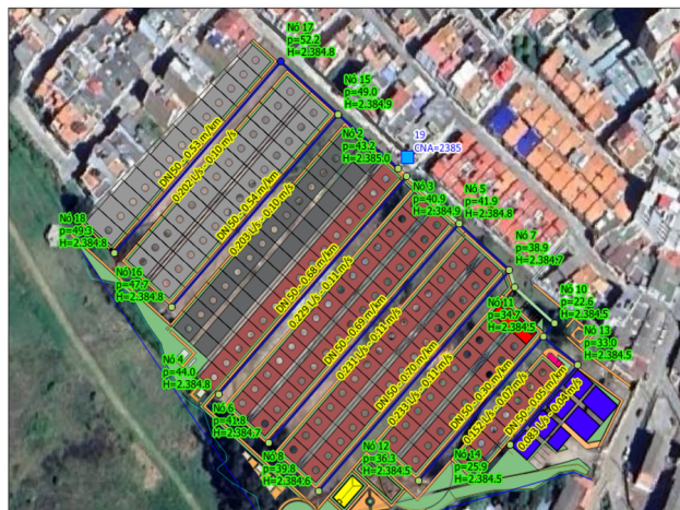
Figura 5. Resultado del análisis hidráulico con QWater del modelo 1.
