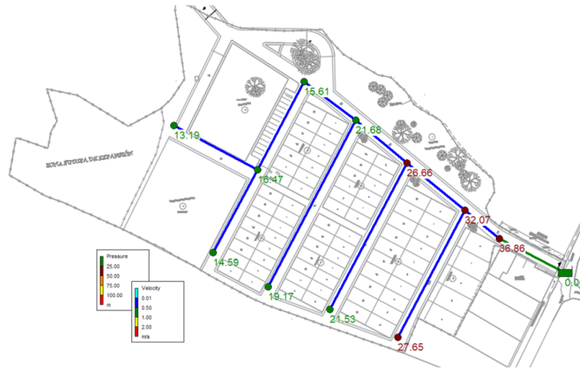
Figura 10. Cálculo hidráulico en EPANET del modelo 2 en la hora 12:00 del día, presiones y velocidad en la RDAP.
