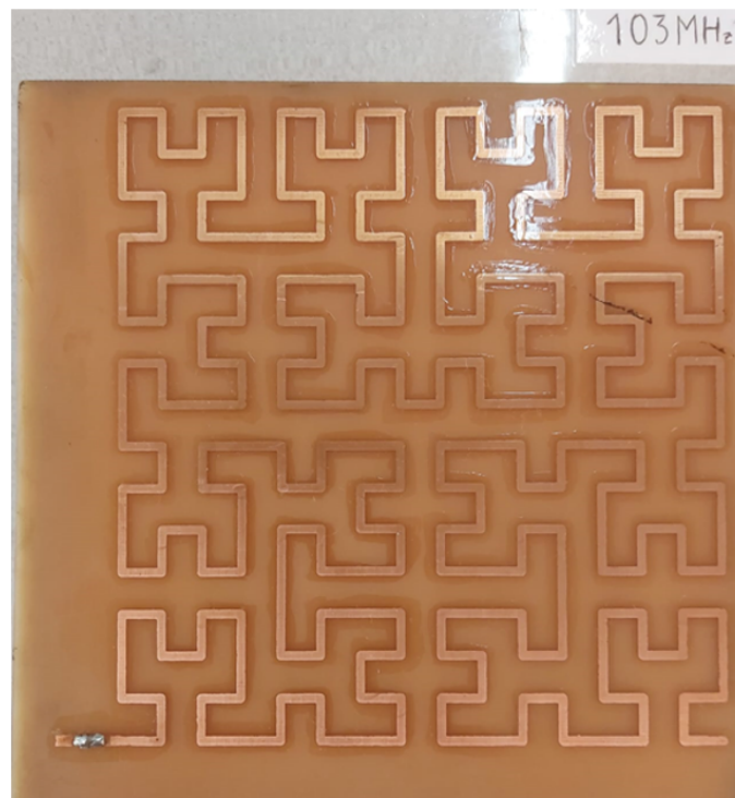
Figura 12. Impresión de antena tipo Fractal de Hilbert para 103MHz.
