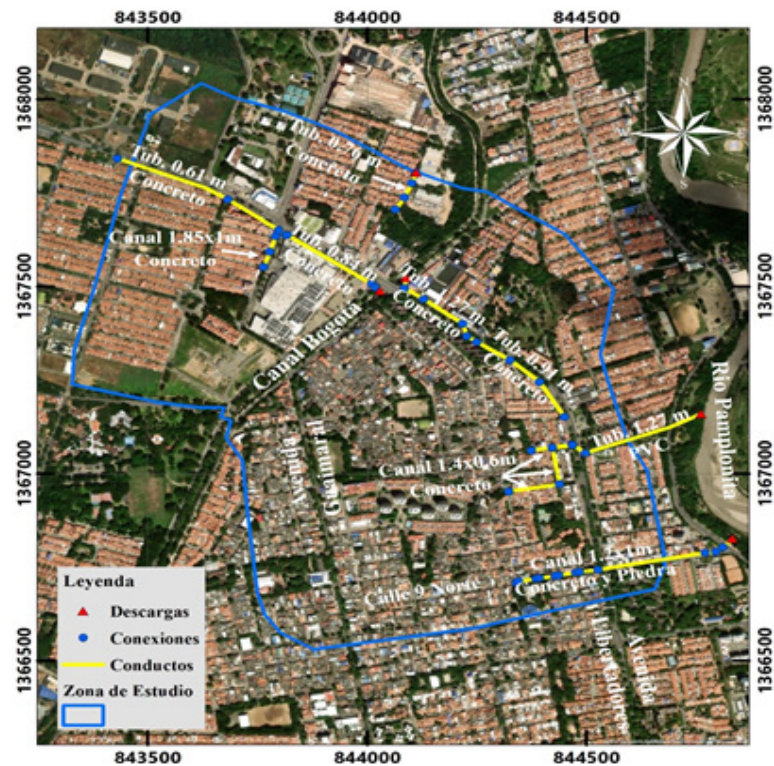
Figura 3. Sistema de drenaje existente en la zona de estudio.
