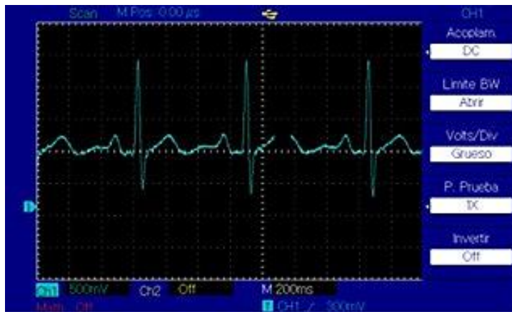
Figura 5. Salida señal derivada II con desplazamiento entre 0 y 5 voltios.. Fuente Propia.
