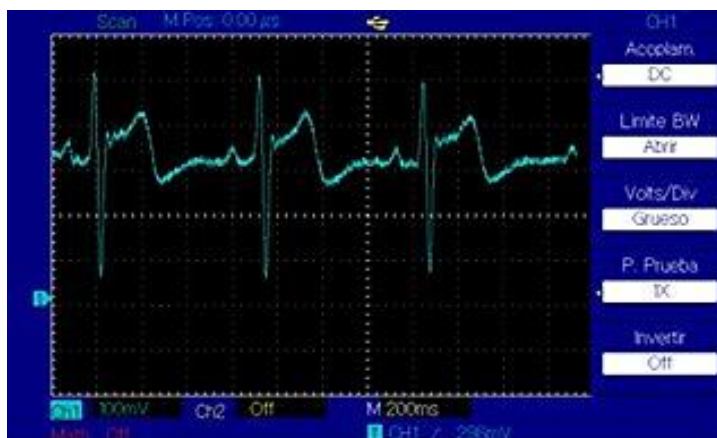
Figura 6. Salida señal derivada III con desplazamiento entre 0 y 5 voltios. Fuente Propia.
