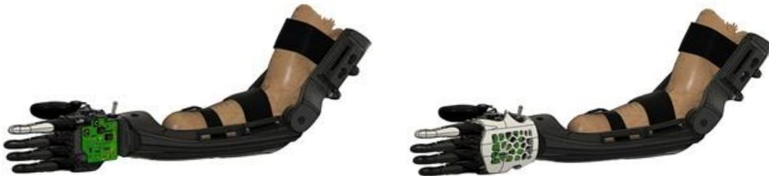
Figura 14. A) Circuito de filtrado en la mano robótica. B) Renderizado del prototipo de la prótesis biónica.
