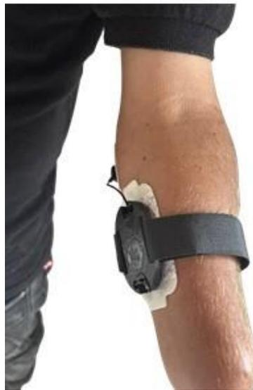
**Figura 3.** Ubicación de la pulsera para la adquisición de la señal EMG en crudo.
