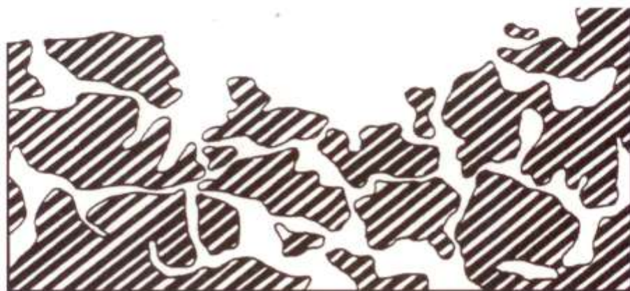
Figura 1A. Dibujo de una sección delgada después de que la muestra de suelo ha sido impregnada y cortada. (Tomado de Dexter, 1976).
